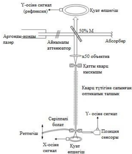
Сурет 1 – Оптикалық талшықтардағы Брэгг торларын жазуға арналған түпнұсқа құрылғының схемасы [6]
